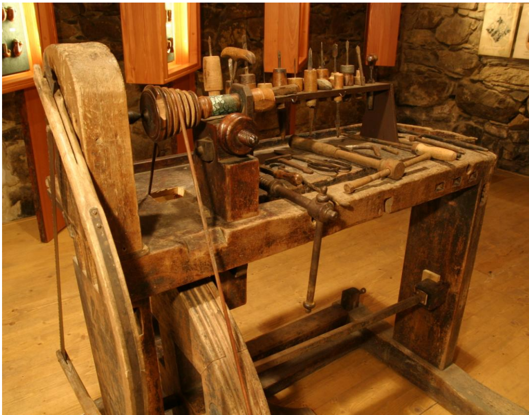
Draxl – šlapací soustruh se sadou nástrojů a některé ukázky ručního pasířského nářadí, v současné době nefunkční a ne zcela kompletní
